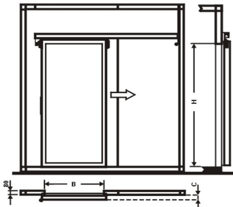
Откатные двери изготовлены из листового крашеного металла с пенополиуретановым наполнителем. По периметру полотно двери укреплено профилем из пищевого алюминия. Дверь снабжена высокоэластичным сменным резиновым уплотнителем. В конструкции применяется специальное запорное устройство позволяющее автоматически под собственным весом двери достигать надежной герметизации.
