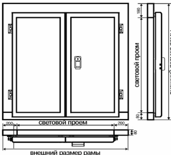
Распашные двухстворчатые двери изготовлены из листового крашеного металла с пенополиуретановым наполнителем. По периметру полотна двери укреплено профилем из пищевого алюминия. Дверь снабжена высокоэластичным сменным резиновым уплотнителем.
