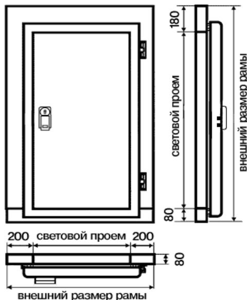
Распашные одностворчатые двери изготовлены из листового крашеного металла с пенополиуретановым наполнителем. По периметру полотна двери укреплено профилем из пищевого алюминия. Дверь снабжена высокоэластичным сменным резиновым уплотнителем.
